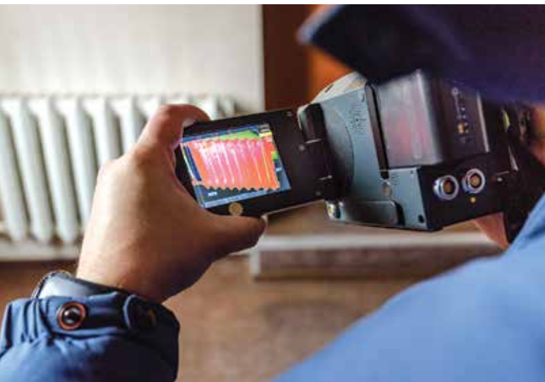
Überprüfung eines Heizkörpers mit einem Thermographen
